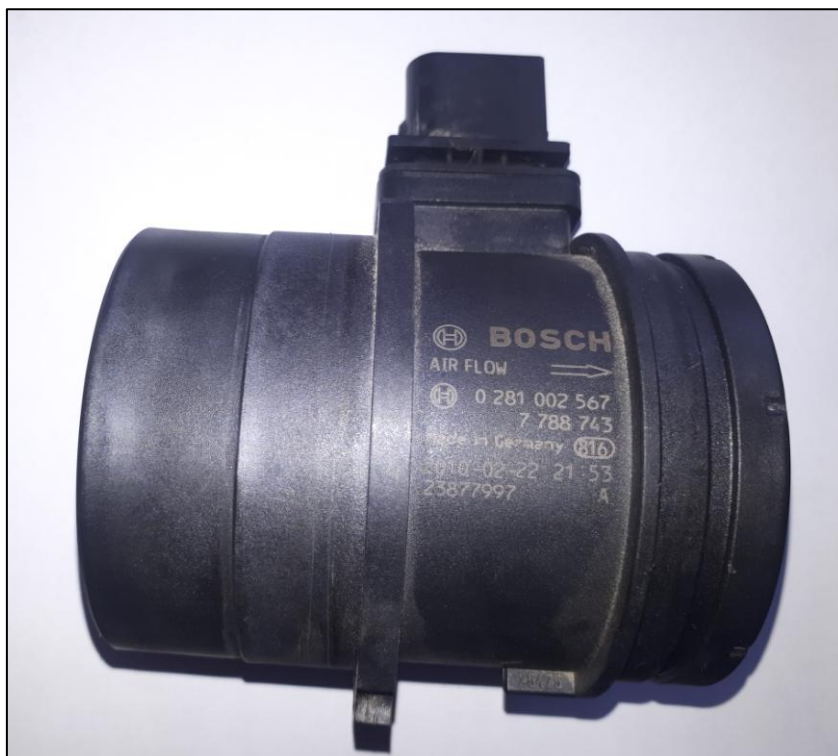
Slika 4.2.1.4. Senzor masenog protoka zraka (MAF senzor)
