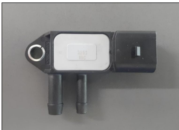
Slika 4.2.3.2. Senzor diferencijalnog tlaka
