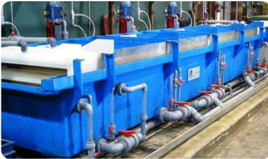
Slika 2.1.3. Višestupnjeviti sistem za dekapiranje[4]
