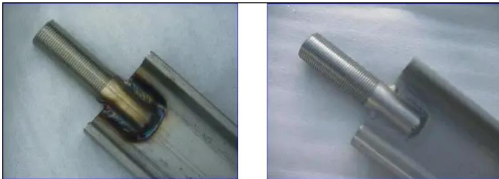
Slika 46: Izgled zavora prije (lijevo) i poslije (desno) nagrivanja [46]
