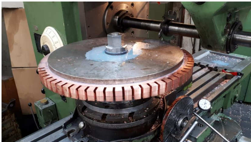
Slika 2.10 Obrada kratkospojnog prstena
