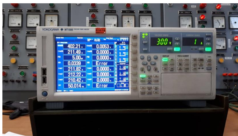
Slika 4.5 Rezultati ispitivanja na analizatoru snage „YOKOGAWA WT1800“
