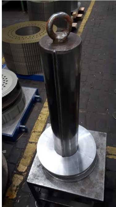
Slika 3.1 Naprava za pakiranje sa postavljenom tlačnom pločom
