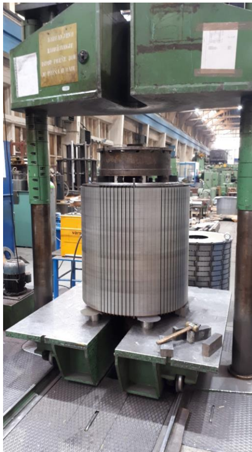
Slika 3.3 Paket spreman za prešanje
