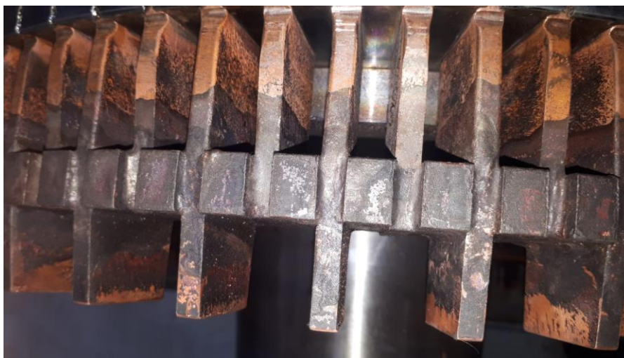
Slika 3.16 Zalemljeni štapovi na kratkospojnom prstenu
