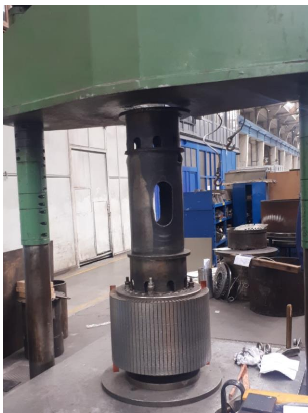
Slika 3.8 Naprešavanje glavine rotora u paket
