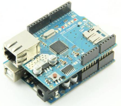
Slika 5-1. Ethernet Shield spojen na Arduino
