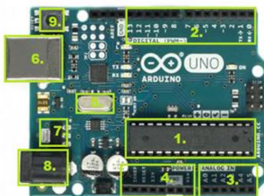
Slika 2-1. Arduino Uno R3 model i najbitniji dijelovi
