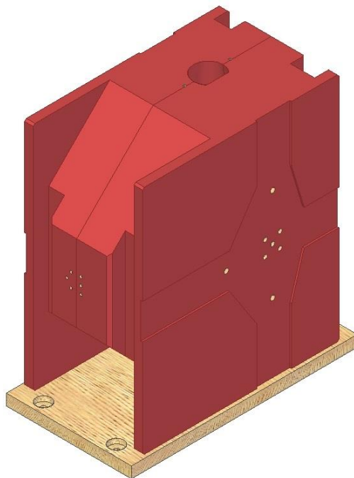
Slika 3.8: Sklop jezgrenika J1 sa podložnom daskom
