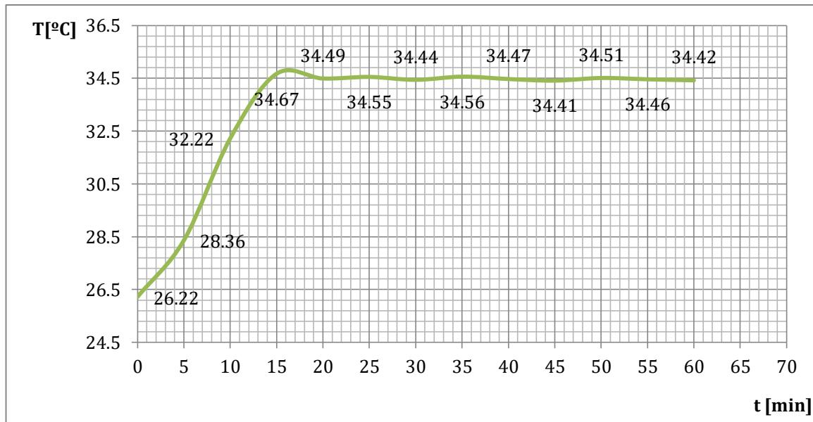
Slika 5.3. Graf Mjerenje temperature komore u dnevnom boravku ( $25^{\circ}\text{C}$ ) s dvije žarulje
