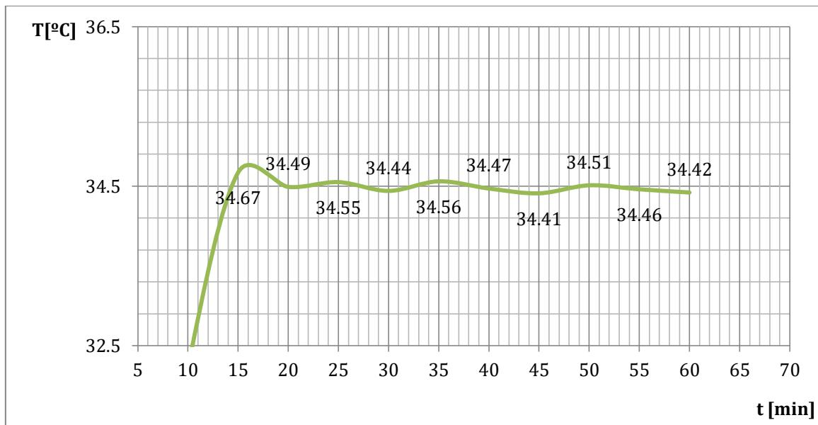
Slika 5.4. Graf Mjerenje temperature komore u dnevnom boravku ( $25^{\circ}\text{C}$ ) s dvije žarulje
