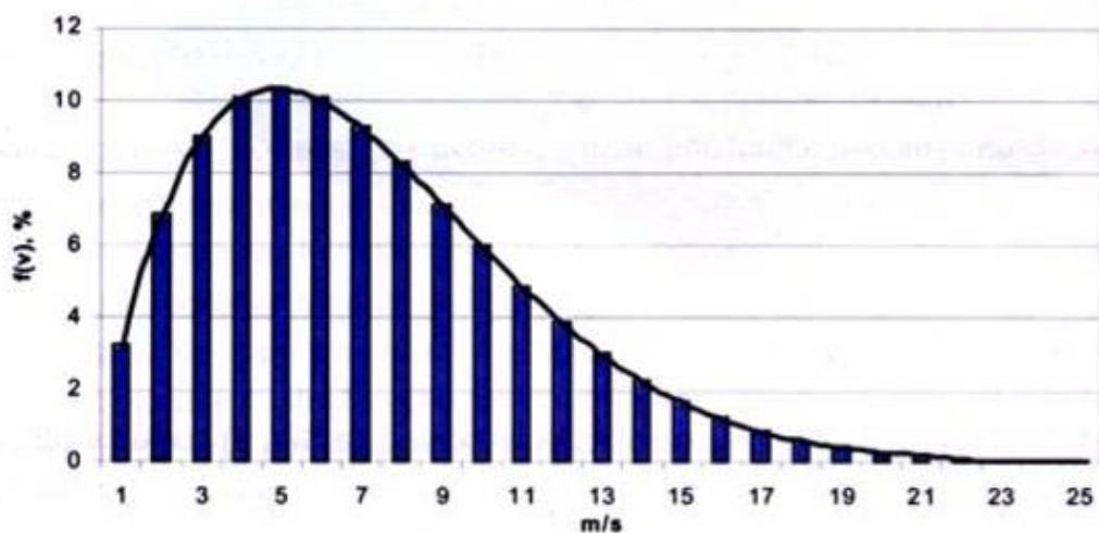
Slika 3.5. Razdioba brzine vjetra (stupci) i pripadajuća Weibullove razdioba (krivulja) [10]
