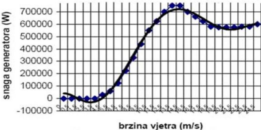
Slika 3.2. Ovisnost snage vjetrogeneratora o brzini vjetra [10]
