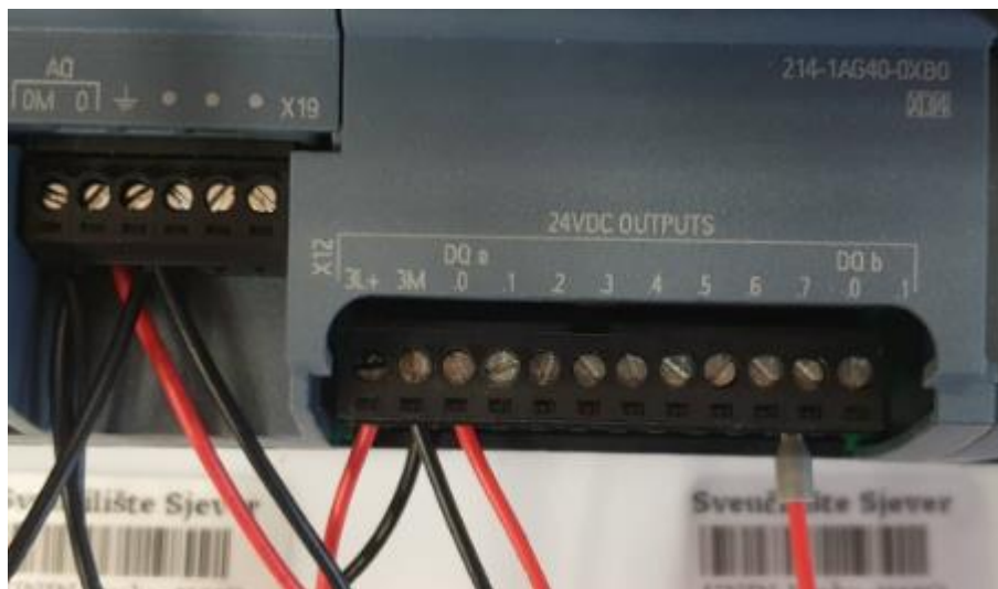
Slika 6.3 Izgled spoja analognih ulaza PLC-a
