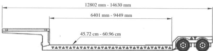
**DVOSTRUKA NISKOPODNA S TRI OSOVINE**
