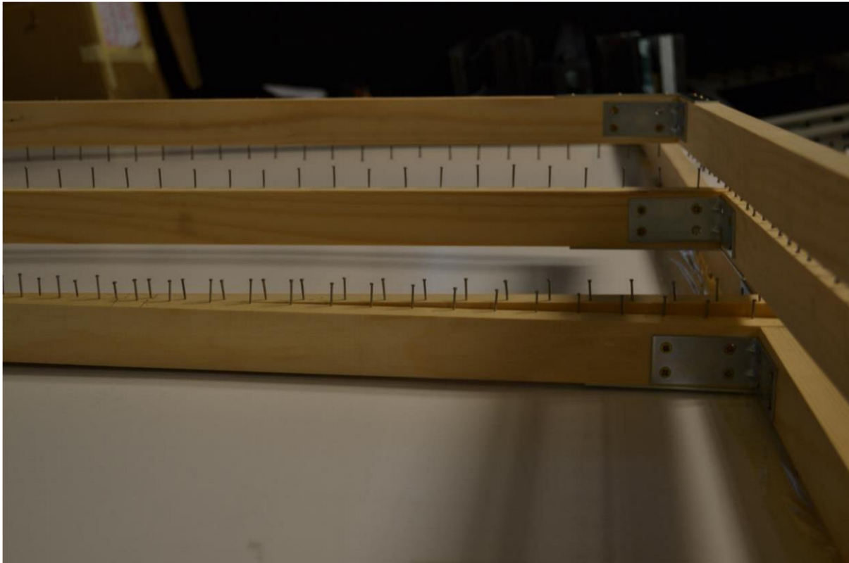
Slika 5.29. Gotove daske sa čavlima spremne za sprejanje
