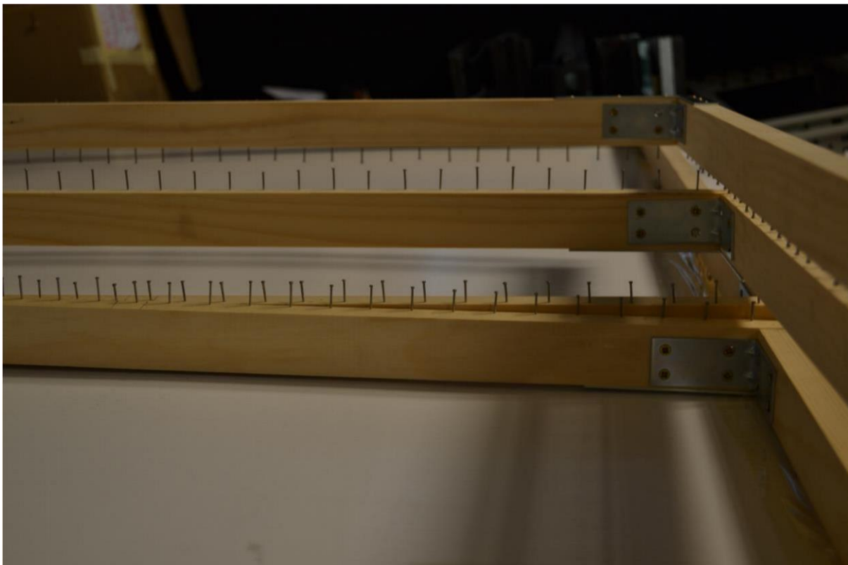
Slika 5.29. Gotove daske sa čavlima spremne za sprejanje
