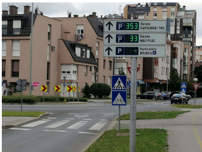
Slika 38. Primjer uputno parkirnog sustava u ulici B. Radić u Varaždinu (Izvor: Fotografija autora)
