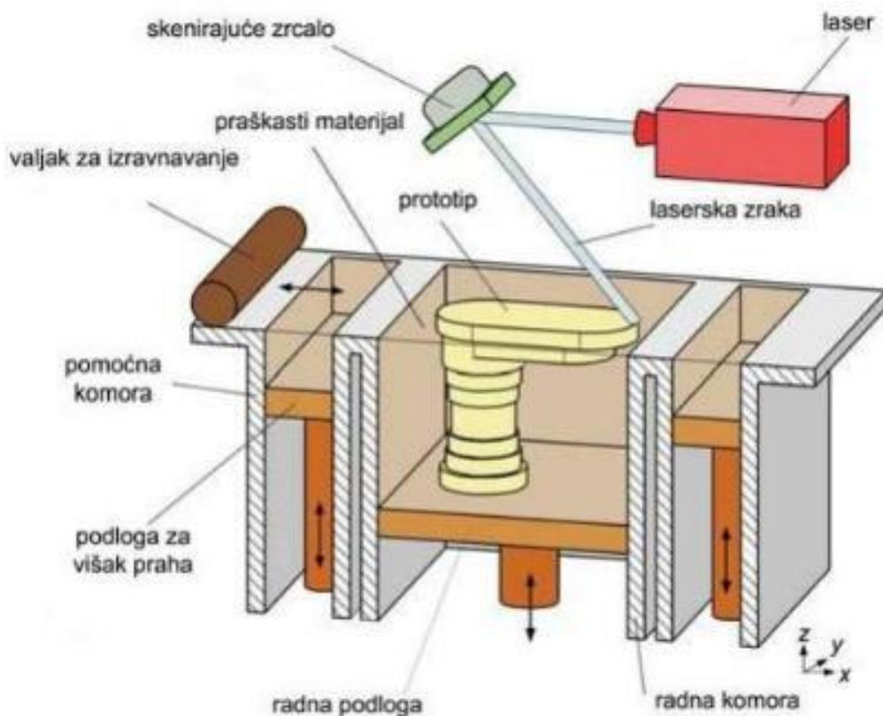
Slika 15. Selektivno lasersko sinteriranje
