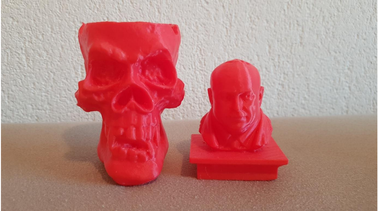
Slika 33. Modeli printani FDM tehnologijom Prusa i3 MK3 pisačem
