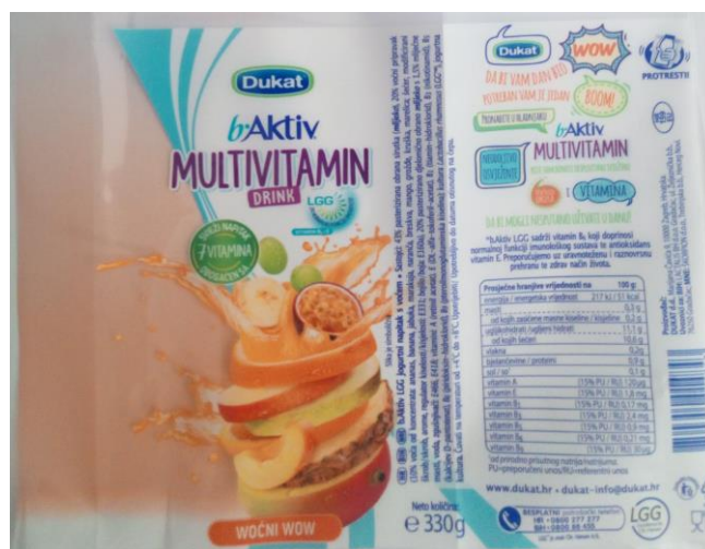
Slika 49. Transparentna etiketa na bez bijele podloge
