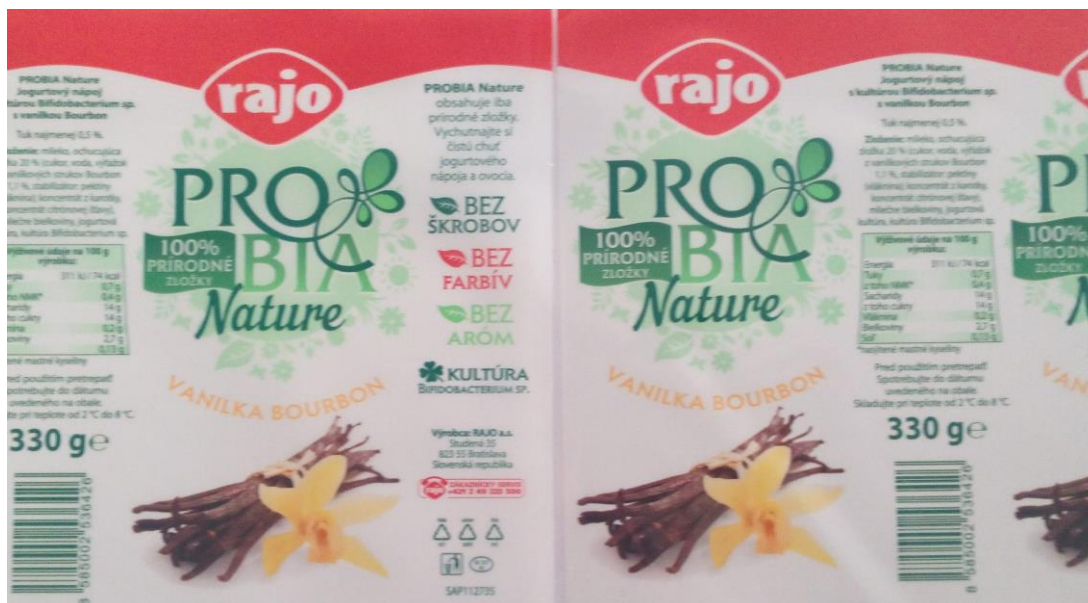
Slika 53. Usporedba etikete sa nanešenim mat lakom i bez
