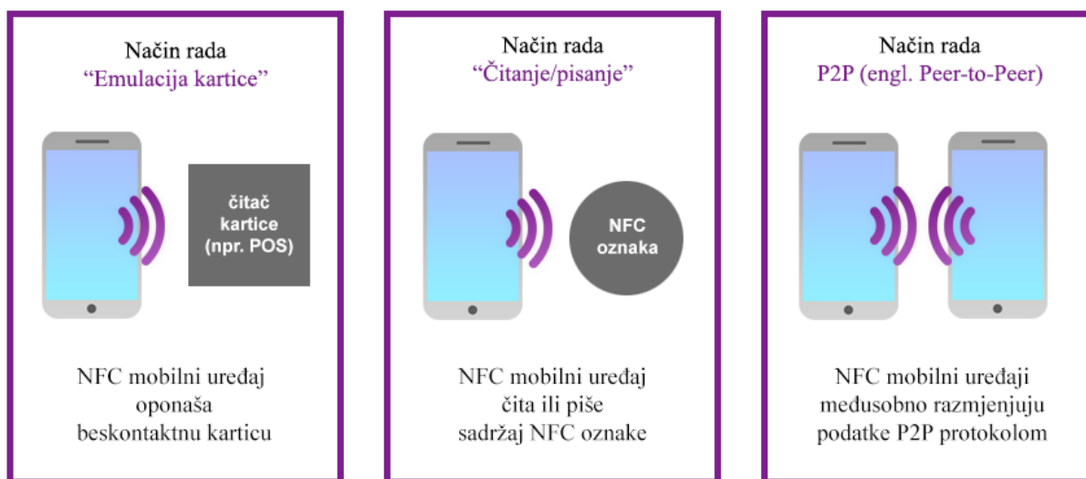
Slika 2. Prikaz uređaja koji sudjeluju u komunikaciji [18] izvor: https://rfid4u.com/nfc-how-it-works
