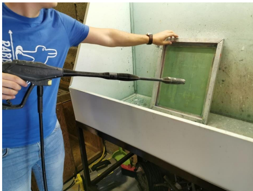
Slika 15: Ispiranje šablone mlazom vode
