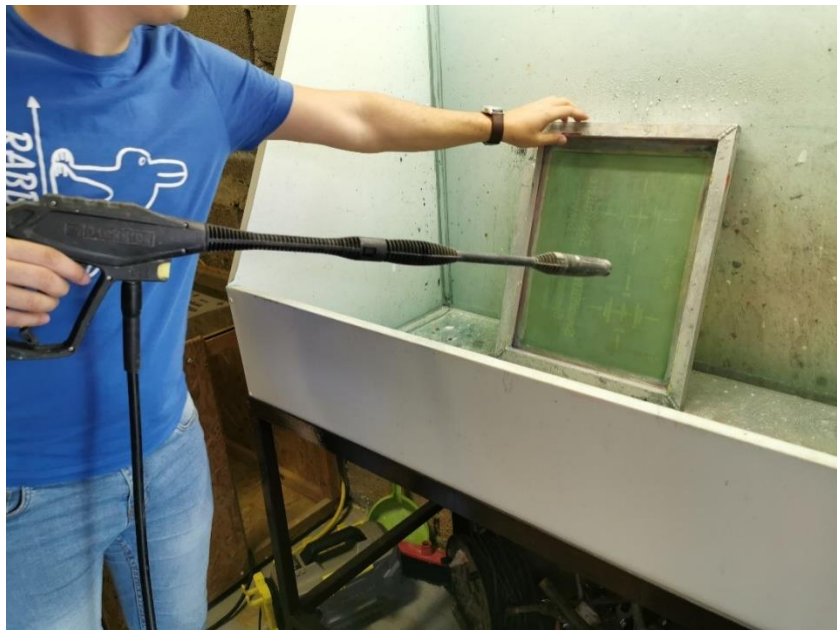
Slika 15: Ispiranje šablone mlazom vode
