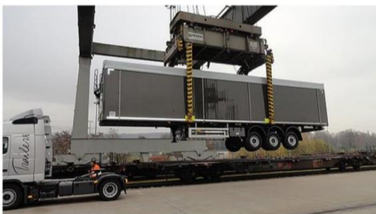
Slika 17. Huckepack tehnologija B
