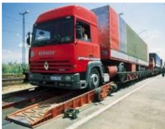
Slika 16. Huckepack tehnologija A
