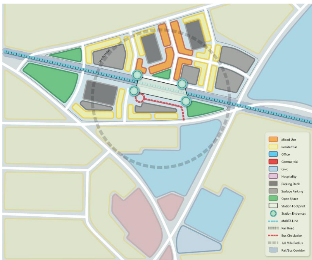
Shema 8 – Primjer uređene zone prema TOD principu s tri ulaza na stajalište/kolodvor sustava javnog prijevoza (prigradsko/izdvojeno naselje), primjer iz Atlante, SAD
