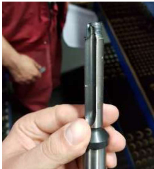
Slika 3.7 Lom AMEC svrdla
