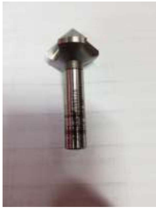
Slika 3.26 Upuštač HSS, kruna ø16, alat i nastavak za krunu
