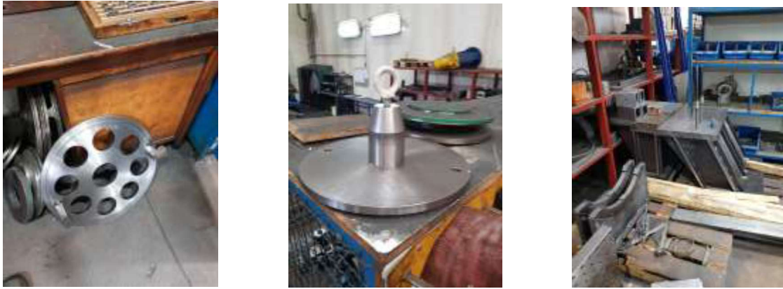
Slika 3.24 Naprave za gornje i donje stezanje
