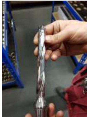
Slika 3.26 Upuštač HSS, kruna \varnothing 16 , alat i nastavak za krunu
