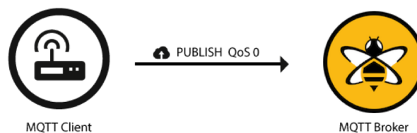
Slika 2.2: Vizualna predodžba razmjene poruka za QoS 0 [19]
