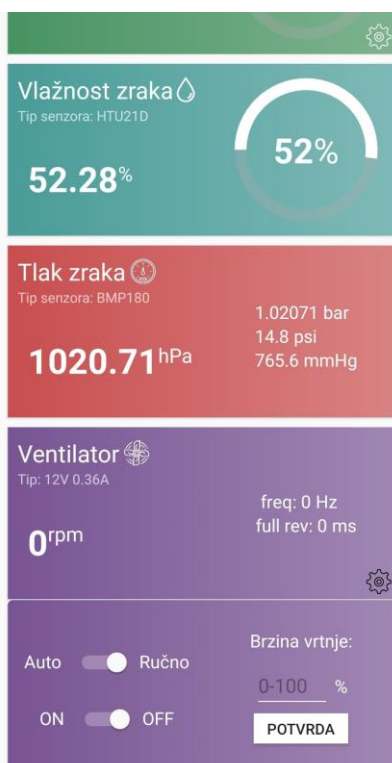
Slika 5.5: Mobilna aplikacija, ručni način - ventilator ugašen
