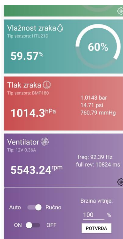
Slika 5.4: Mobilna aplikacija, ručni način - ventilator na 100% brzine
