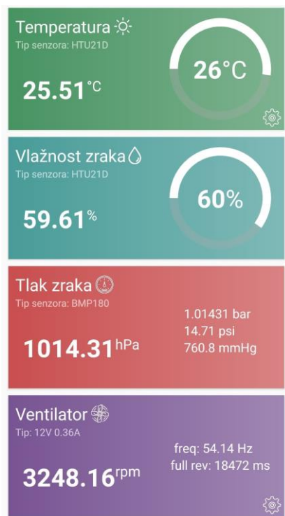
Slika 5.2: Mobilna aplikacija, temperatura - Celzijus
