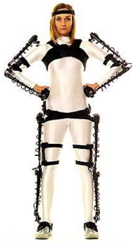
Slika 3.7 Primjer mocap odijela sa mehaničkim sensorima
