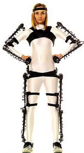
Slika 3.7 Primjer mocap odijela sa mehaničkim sensorima
