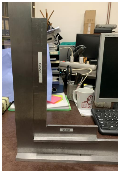
Slika 6.27. Kutnik - kontrola vanjskog kuta pomoću kontrolnog kutnika [10]
