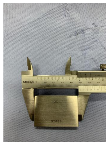
Slika 6.20. Pomično mjerilo – provjera sa etalomom duljine 50 [mm] [10]
