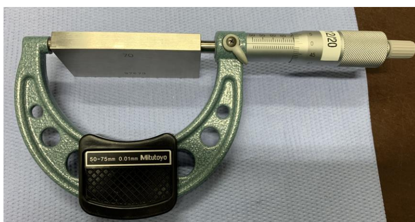
Slika 6.26. Mikrometar – provjera sa etalonom duljine 70 [mm] [10]
