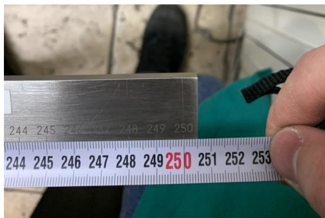
Slika 6.30. Čelični metar, uspoređivanje vrijednosti sa mjernom letvom [10]
