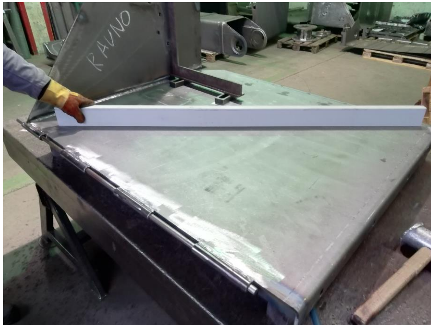
Slika 6.15. Kontrola ravnosti metalnim ravnalom (libelom) [10]
