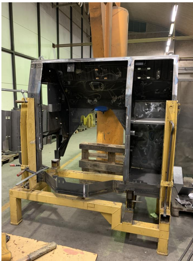
Slika 6.4. Proizvod „PUMPENKASTEN“ u napravi [10]
