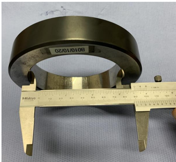
Slika 6.22. Pomično mjerilo – provjera sa prstenom promjera 80 [mm] [10]
