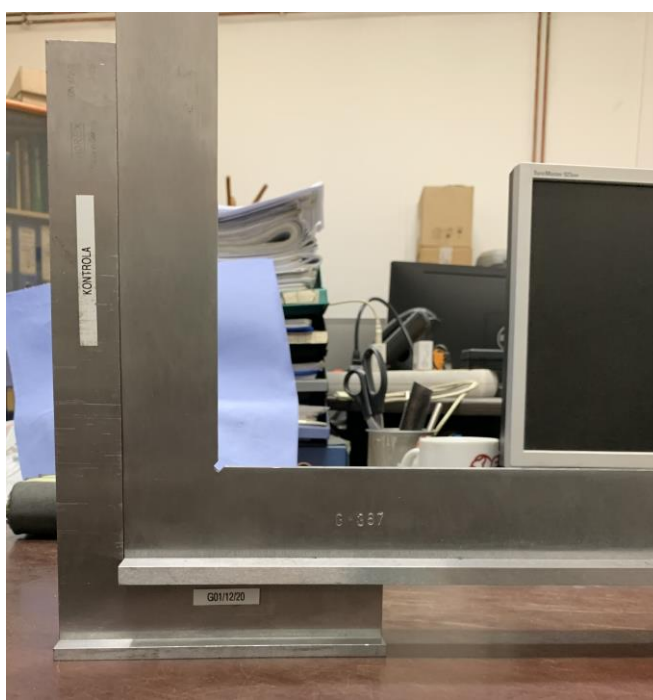
Slika 6.28. Kutnik - kontrola unutarnjeg kuta pomoću kontrolnog kutnika [10]
