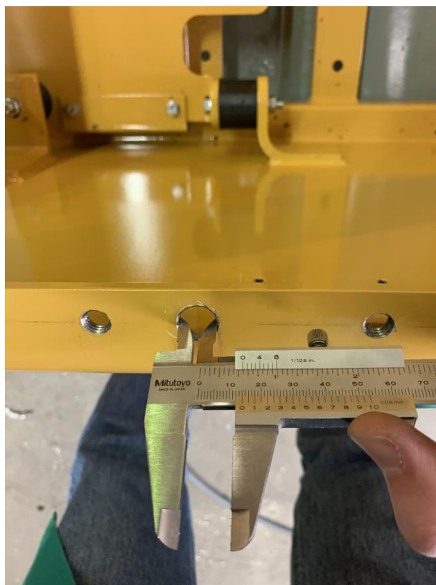
Slika 6.12. Kontrola promjera rupe sa pomičnim mjerilom (kljunovi za unutrašnje mjere) [10]
