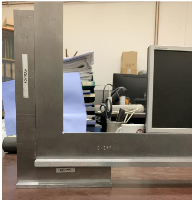
Slika 6.28. Kutnik - kontrola unutarnjeg kuta pomoću kontrolnog kutnika [10]
