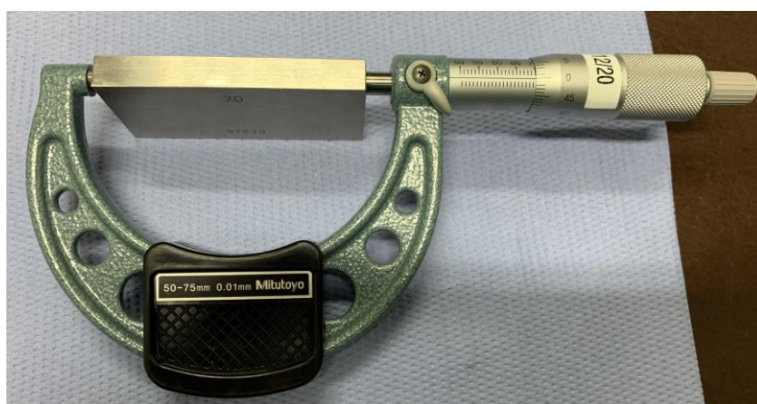
Slika 6.26. Mikrometar – provjera sa etalonom duljine 70 [mm] [10]
