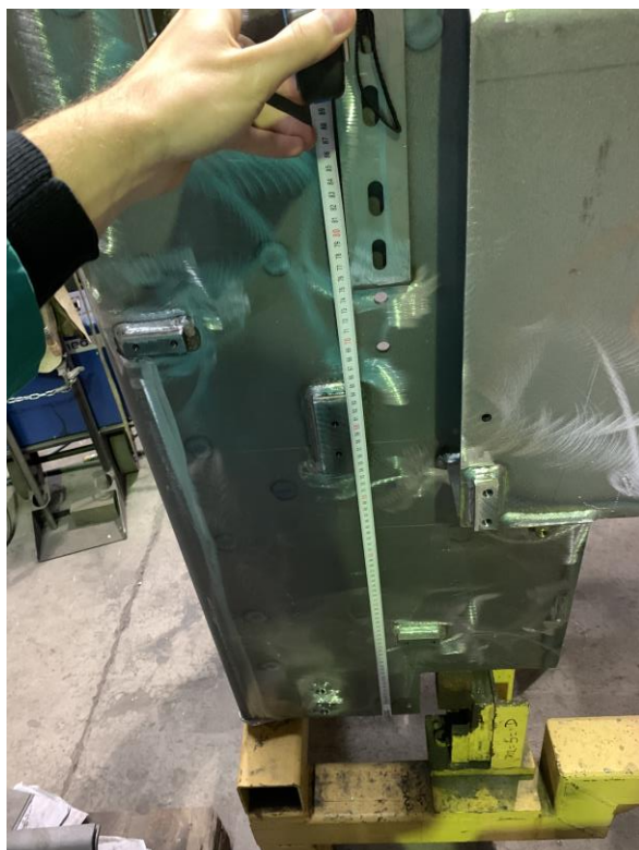
Slika 6.8. kontrola pozicije 56 pomoću čeličnog metra [10]
