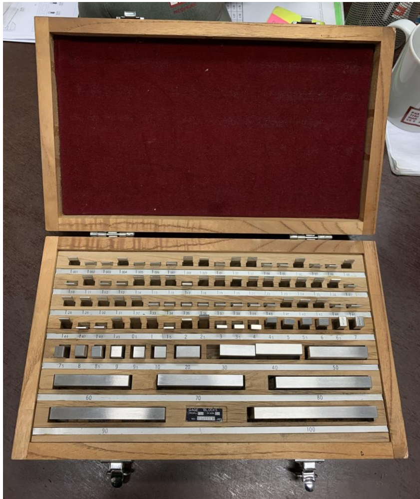
Slika 6.16. Etaloni za umjeravanje mjernih instrumenata [10]
