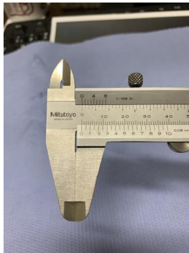
Slika 6.18. Pomično mjerilo -vizualni pregled stanja i zazora između mjernih površina [10]
