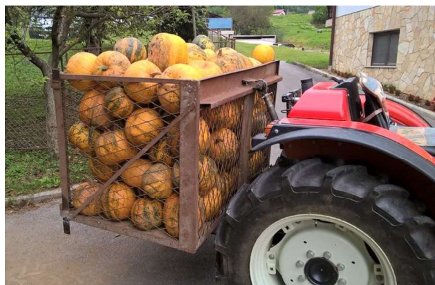
Slika 10: Primjer spajanja traktorskog sanduka pomoću poteznice [15]
