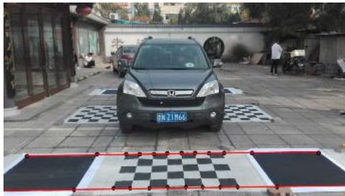
Slika 3.8 Specijalna kalibracijska ploča (označena crvenim linijama).
