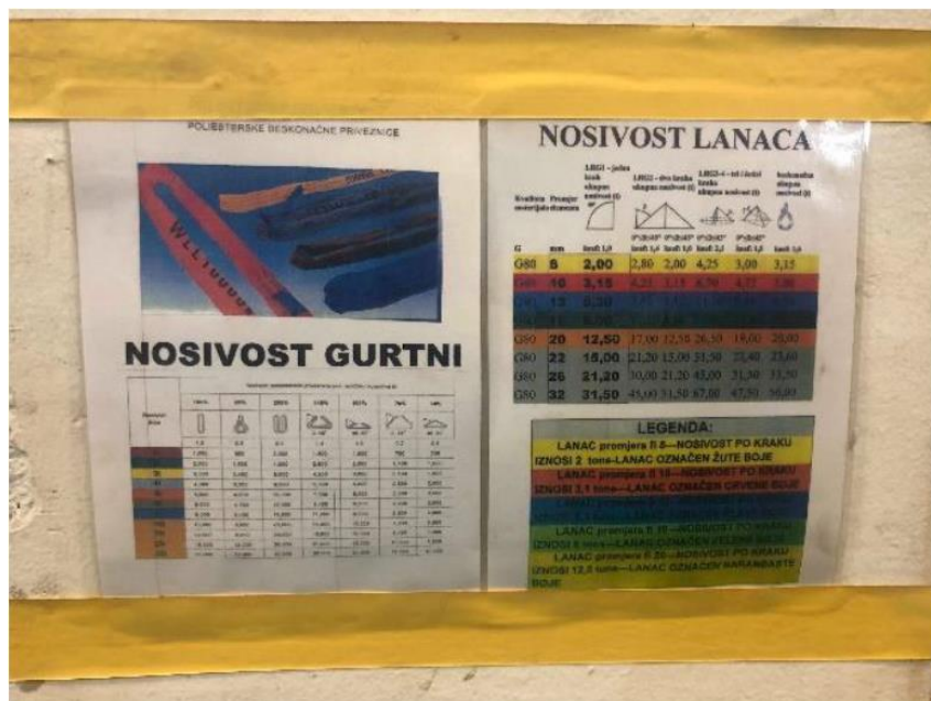
Slika 42. Oznake nosivosti gurti i lanaca za kran
