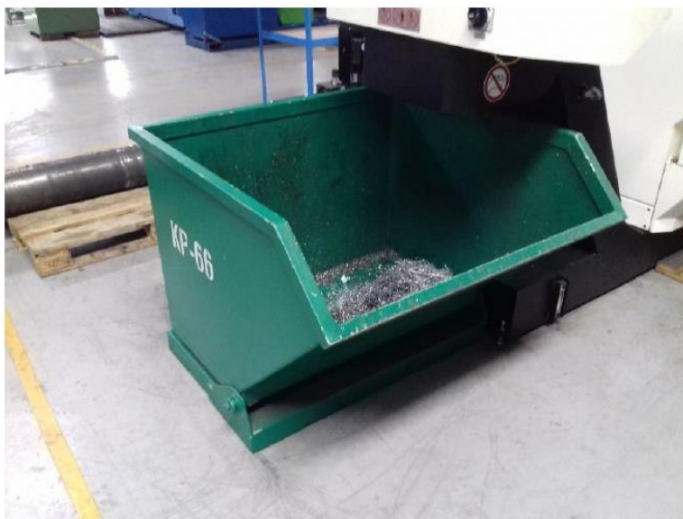
Slika 28. Metalni kontejner za skupljanje otpadnog materijala
