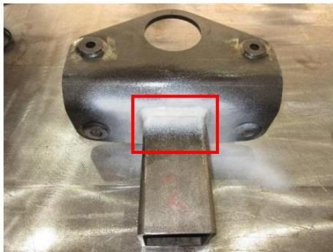
Bild 1: Übersicht Bauteil und Prüfbereich (SN umlaufend)
