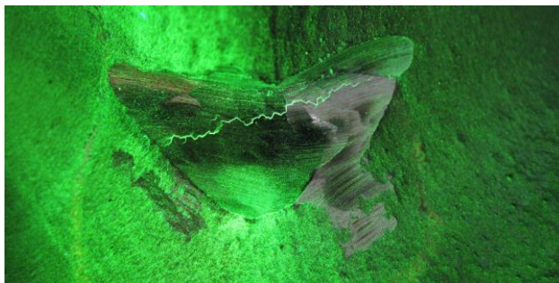
Slika 7 Pukotina zavara detektirana MT [7]
