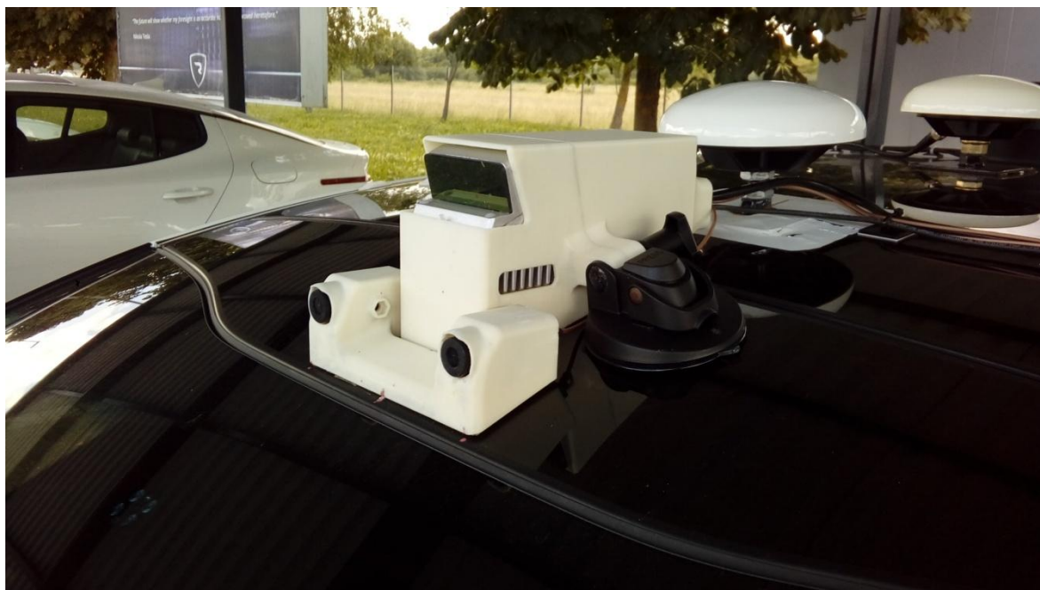
Slika 13: 3D isprintano kućište senzora
