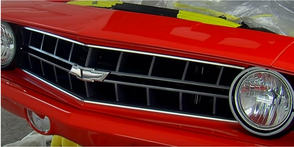
Slika 5: 3D isprintana maska za Camara iz 1969.
