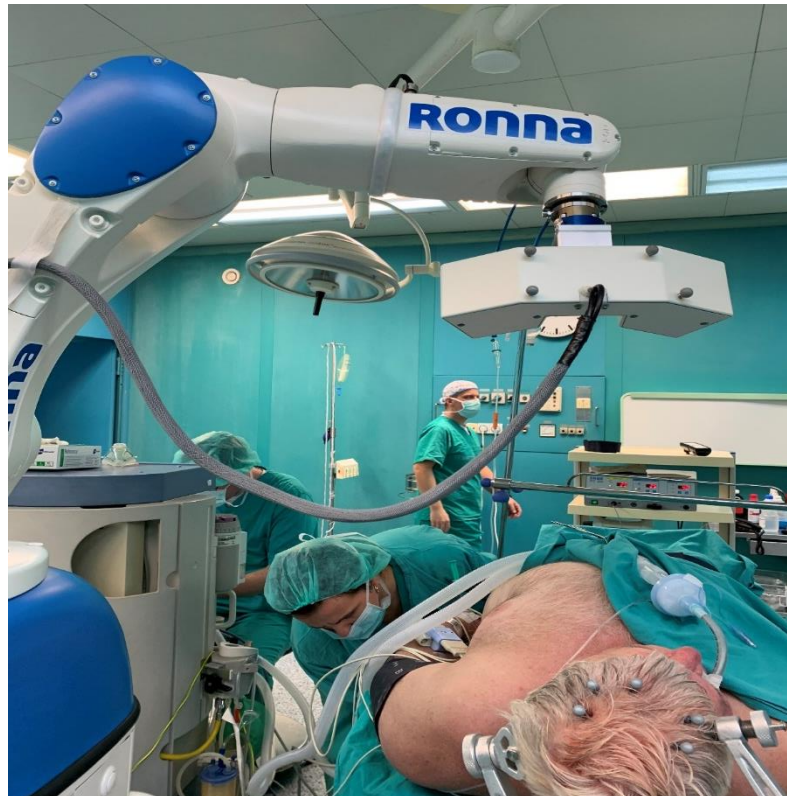
Slika 7.3.4. Registracija markera učvršćenih na glavi bolesnika koja se nalazi na Mayfield nastavku (Izvor:autor)
