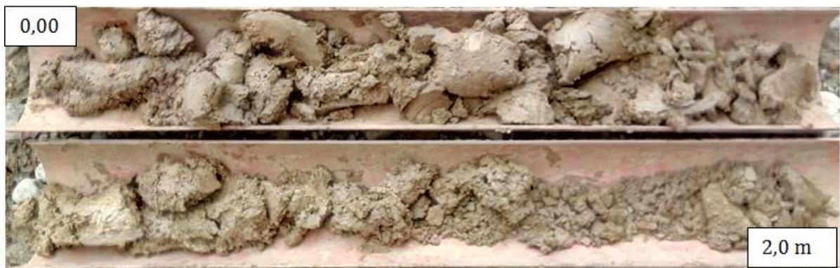
Slika 6.4. Nabušena jezgra bušotine B1
