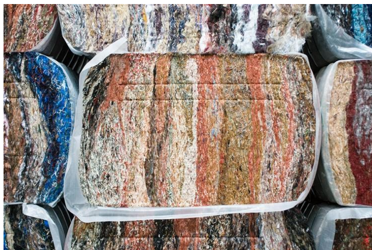
Slika 5.8: Vlakna dobivena reciklažom
