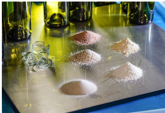
Slika 11. Sirovine za proizvodnju ambalažnog stakla
