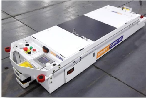
Slika 34. AGV vozilo jediničnih tereta
