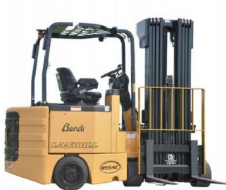
Slika 11. Viličar sa zakretnim jarbolom
