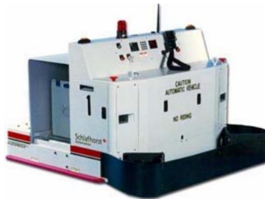
Slika 33. Vučno AGV vozilo
