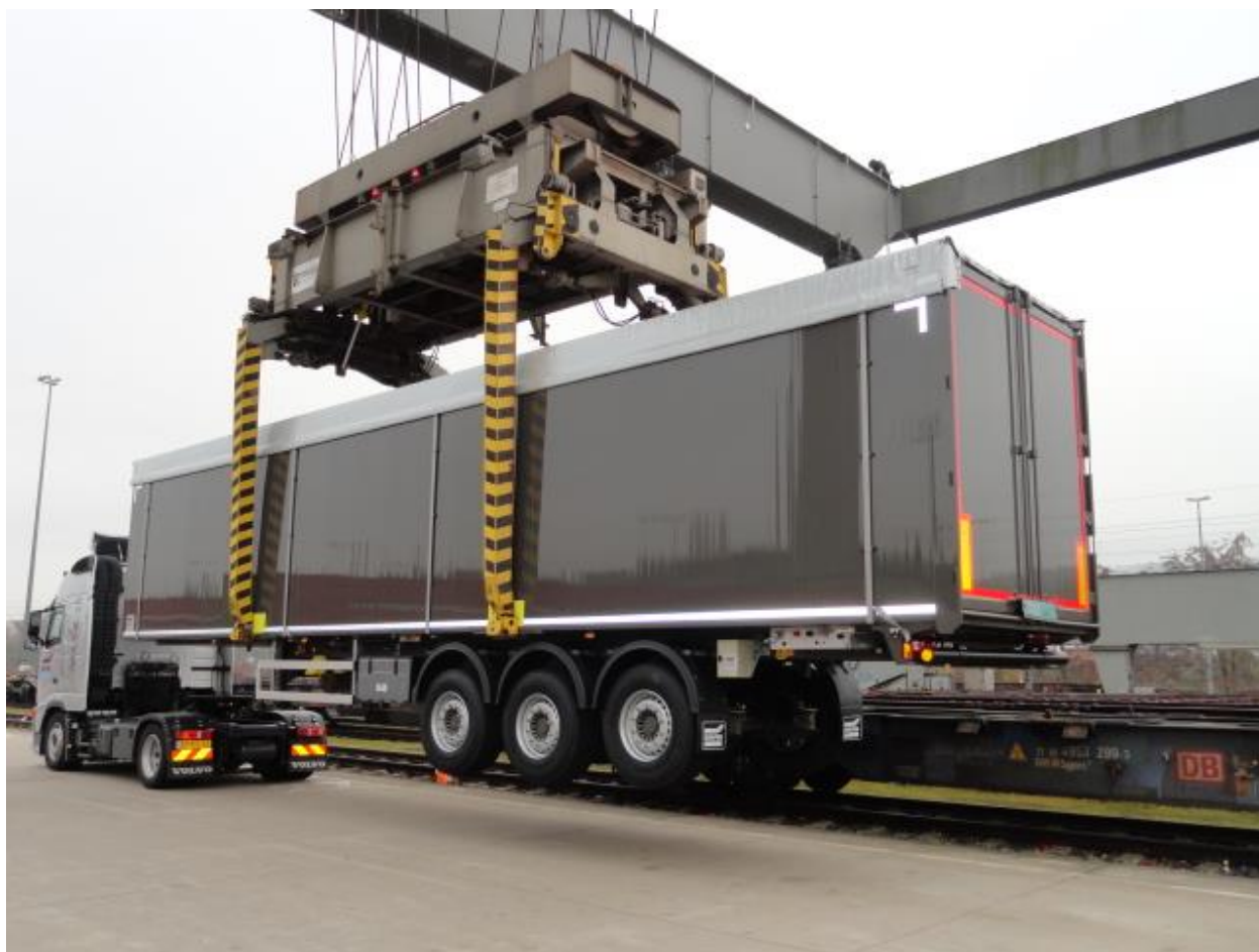
Slika 9. Vertikalni ukrcaj poluprikolice kod Huckepack tehnologije B [8]
