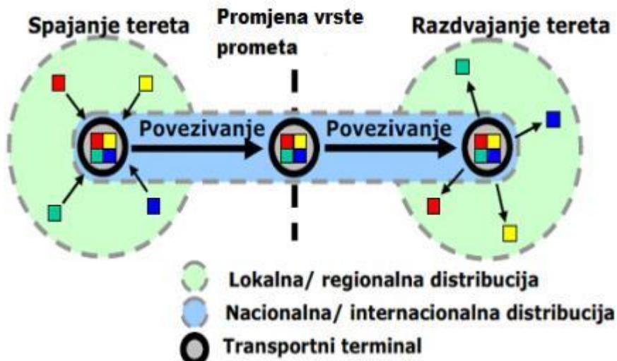
Slika 2. Procesi unutar intermodalnog transportnog lanca [14]
