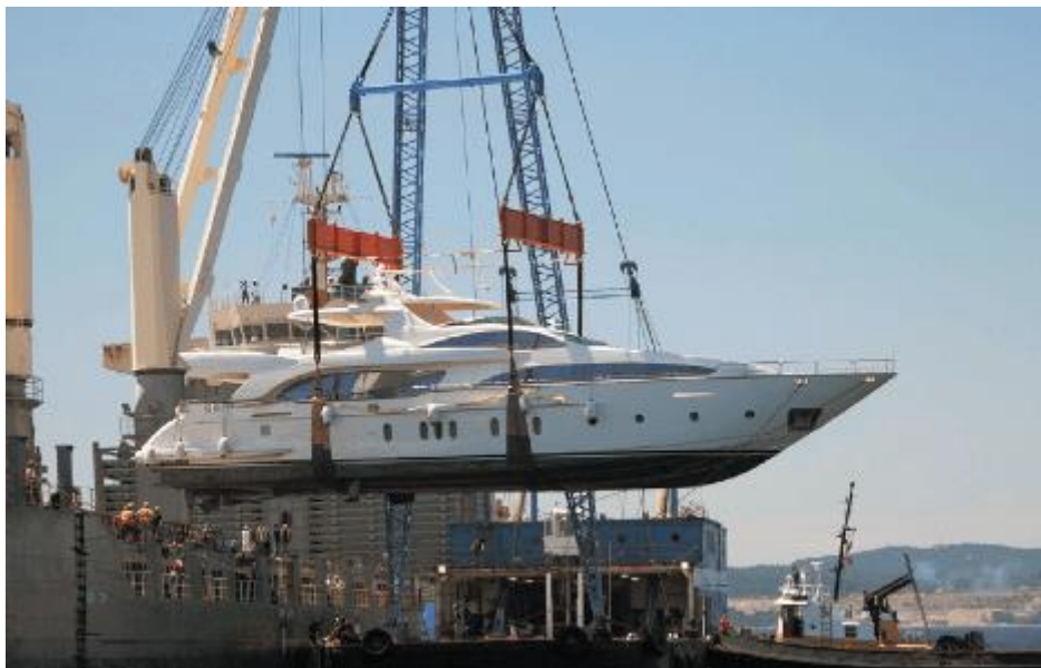
Slika 6. Prikaz tehnologije LO-LO sustava [6]
