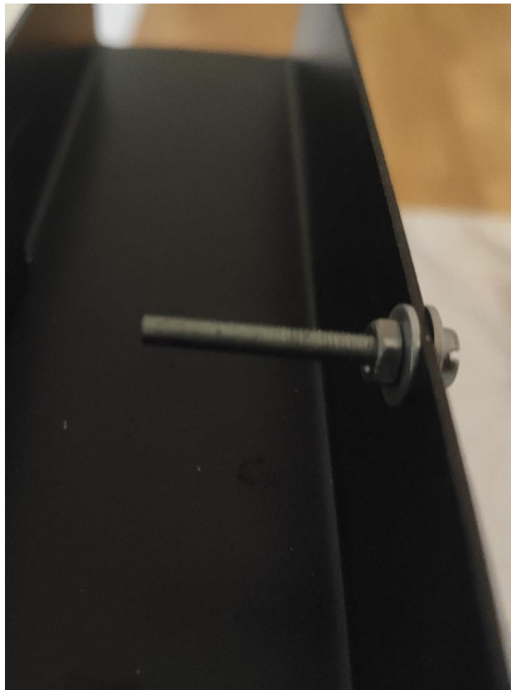
Slika 4.4 Prikaz montiranog graničnika
