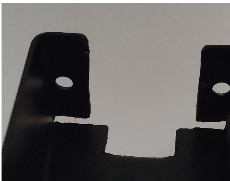
Slika 4.3 Prilagodba lima grede montaži senzora
