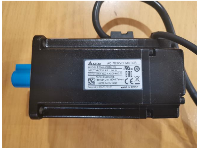
Slika 3.5 Servo motor s natpisnom pločicom
