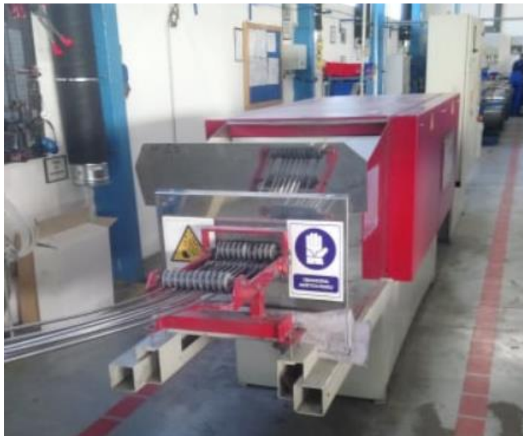
Slika 31 Peć za toplinsku obradu cijevi
