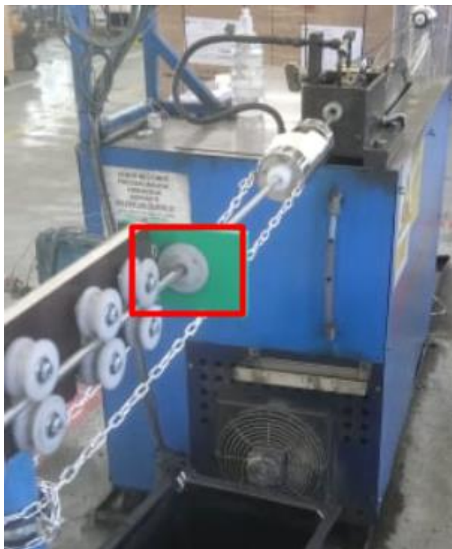
Slika 33 Kontrola od pukotina prije kalibriranja
