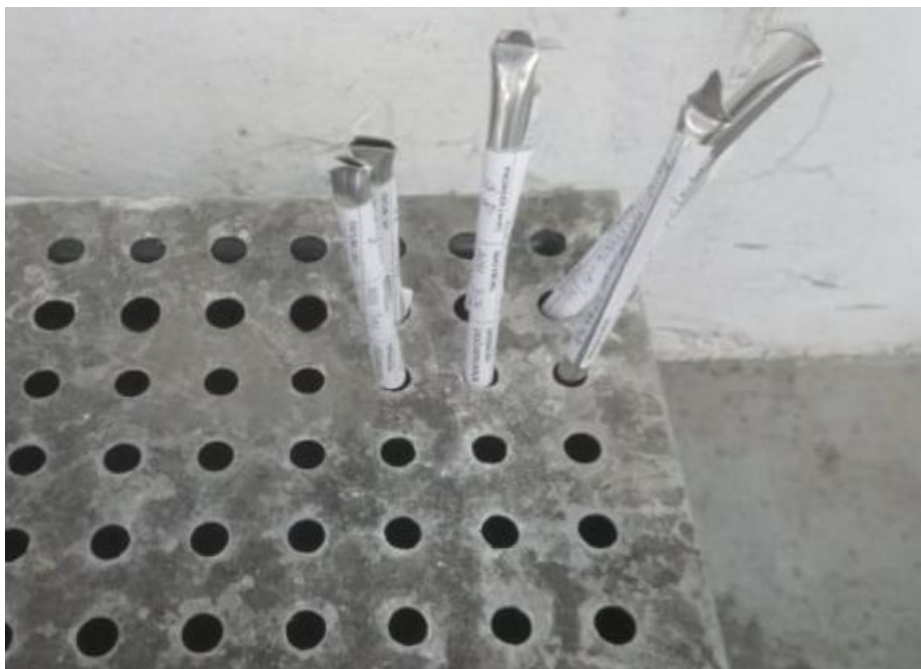
Slika 37 Ispitivanje cijevi u vodenoj otopini natrijevog klorida
