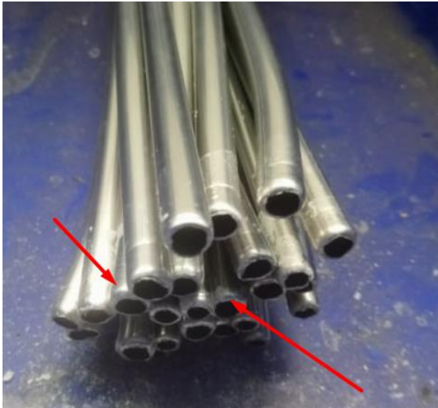
Slika 38 Ispitni uzorci nakon ispitivanja u vodenoj otopini natrijevog klorida
