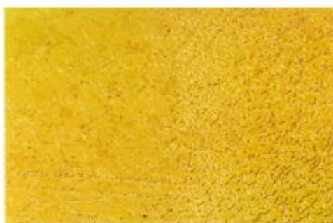
a) Razlike u strukturi: lijevo – osnovni metal desno – metal zavara
