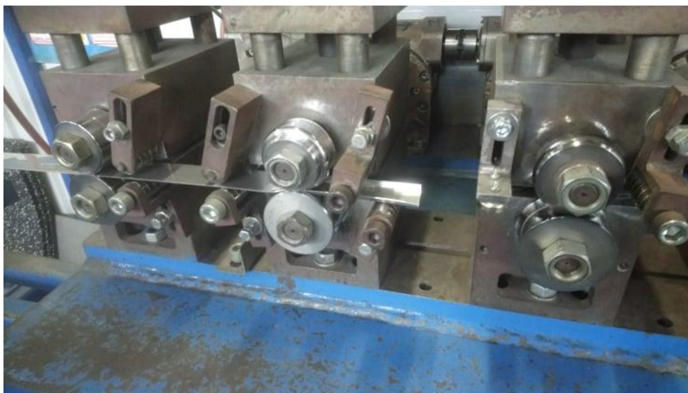
Slika 21 Prvi korak savijanja trake
