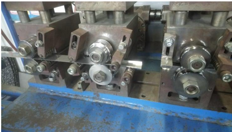
Slika 21 Prvi korak savijanja trake
