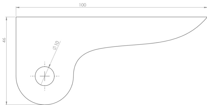
Slika 3.11 Nosač ležaja podiznog okvira
