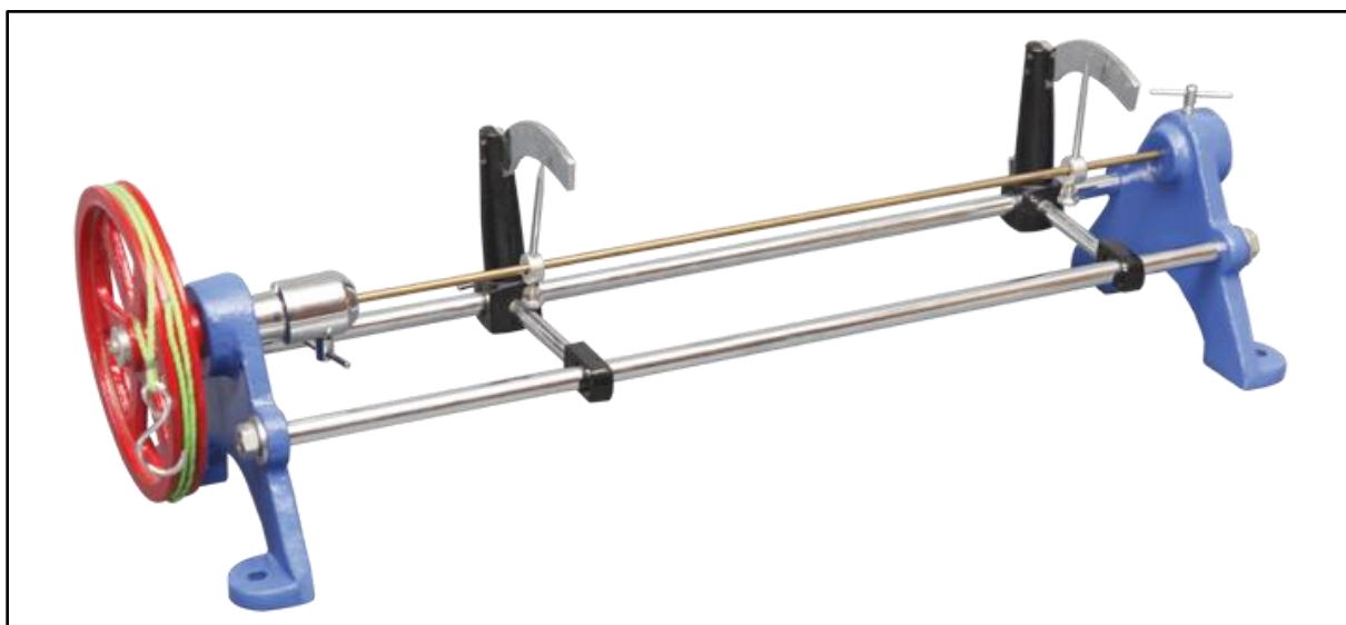
Slika 1.1 Komercijalna naprava za test uvijanja
