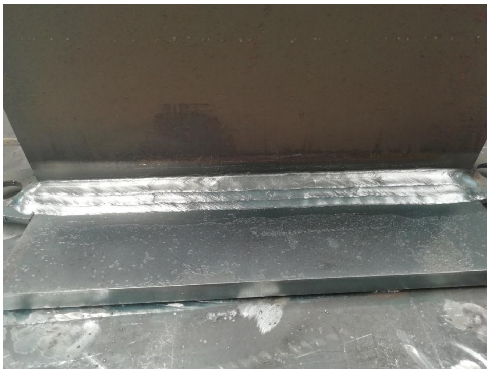
Slika 9.8. Zavaren ispitni uzorak kutnog spoja
