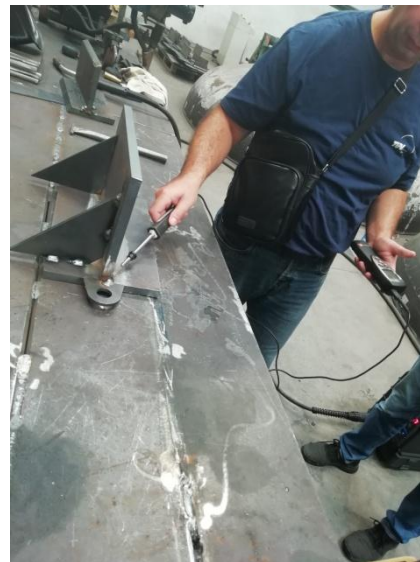
Slike 9.9.i 9.10. Mjerenje međuprolazne temperature
