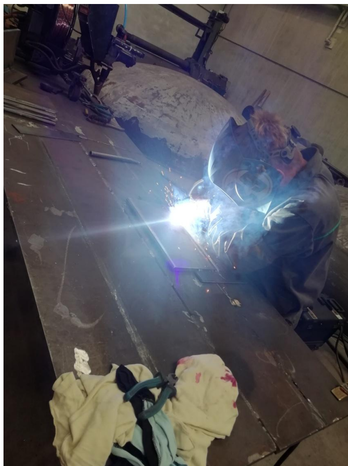
Slika 9.3. Zavarivanje popune sučeljenog spoja u PA položaju
