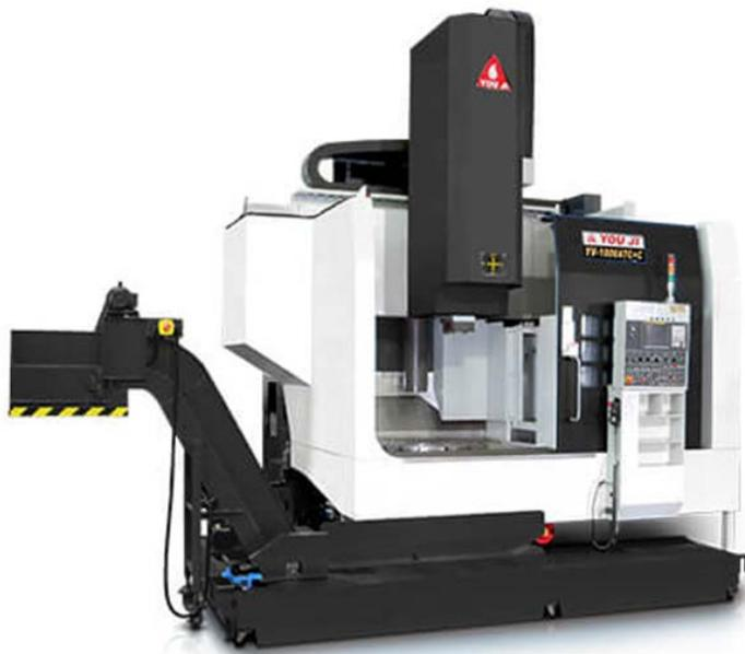
*Slika 3: Vertikalni tokarski obradni centar*
