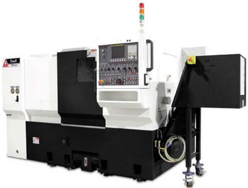
Slika 4: Horizontalni tokarski obradni centar
