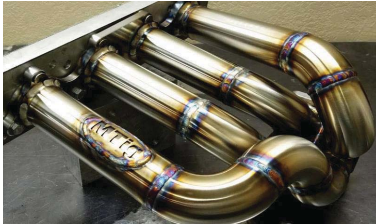
Slika 14. Proizvod izveden TIG postupkom zavarivanja
