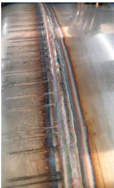
Slika 52. Lice zavara plašta i podnice
