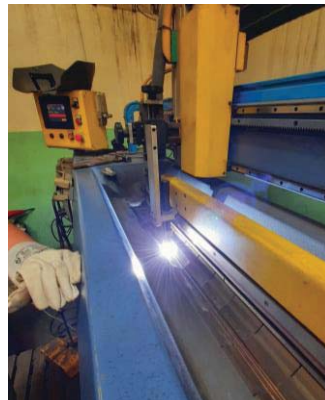
Slika 46. Postupak uzdužnog zavarivanja plašta
