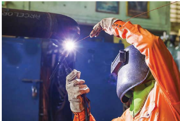
Slika 12. Ručno TIG zavarivanje
