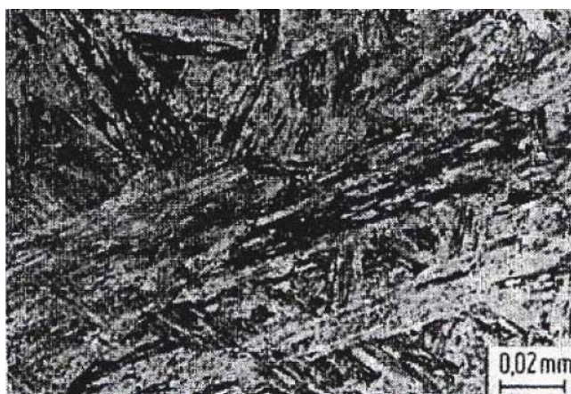
Slika 4. Martenzitna mikrostruktura nehrđajućih čelika
