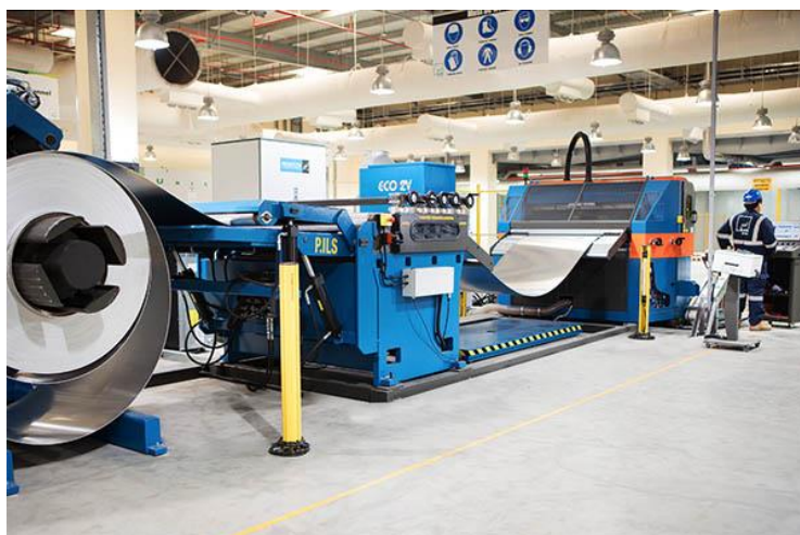
Slika 30. Linija za odmatanje, ravnanje, kružno poliranje i lasersko rezanje lima
