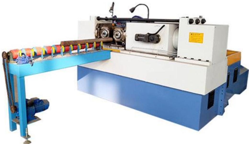
*Slika 3.20 Automatski stroj za valjanje navoja [30]*
