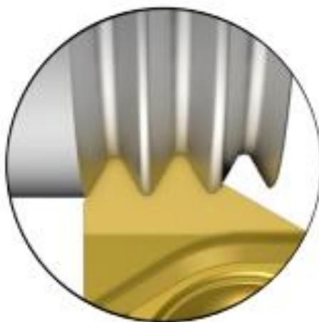
Slika 3.7 Rezna pločica sa više zubi [9]
