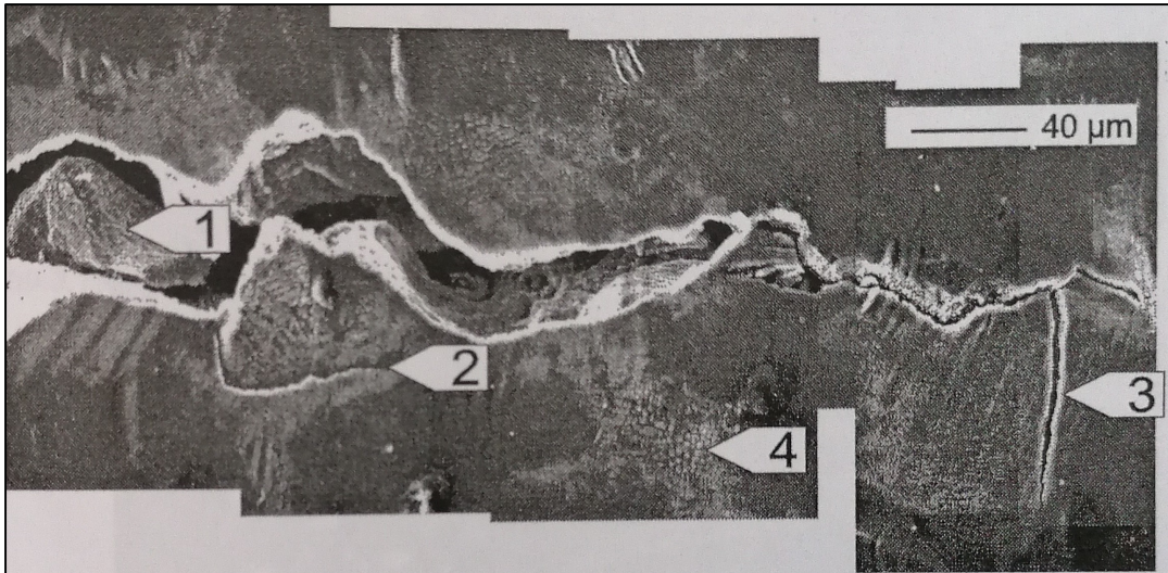
Slika 4.5 SEM slika tople pukotine na leguri AW 6016 [16]
