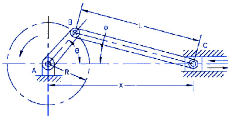
Slika 2.3: Mehanizam za pretvaranje kružnog gibanja u linearno [4]
