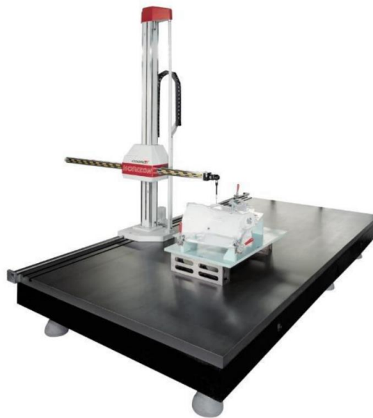
Slika 4. Horizontalni tip koordinatnog mjernog uređaja [5]
