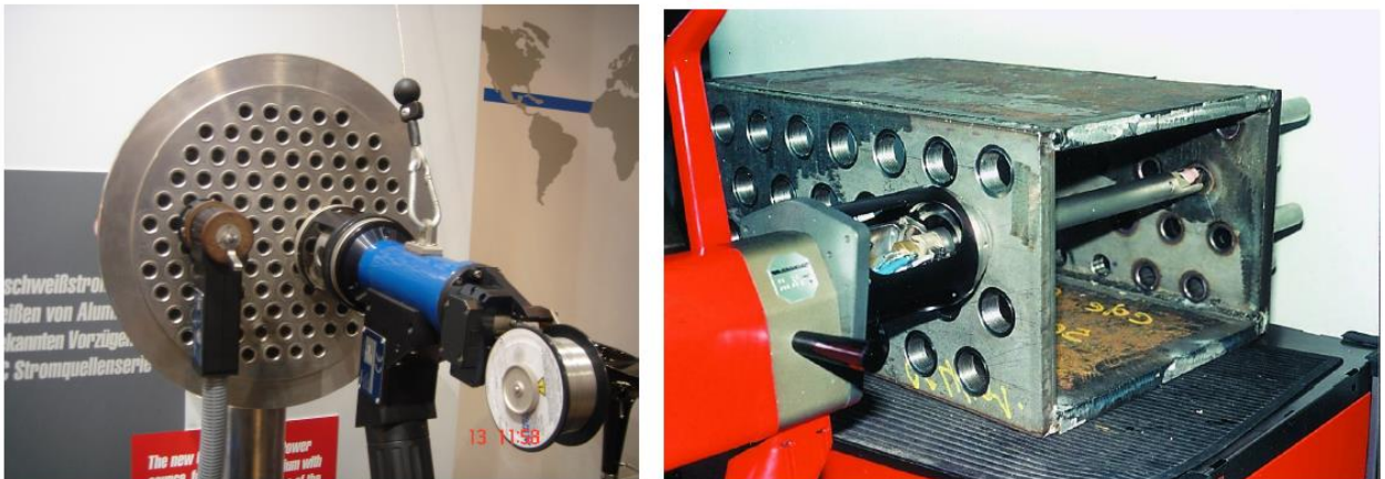
Slika 2.35 Glave za zavarivanje cijevi u cijevnu stijenu [37]
