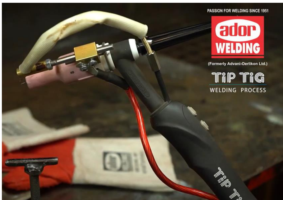
Tablica 2.6 TIG pištolj sa ugrađenim sustavom dobave žice [26]
