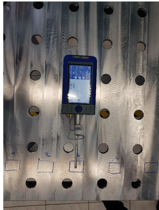
Slika 91. Mjerenje površinske hrapavosti na području 3
