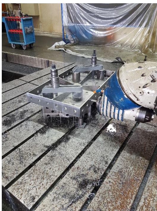
Slika 75. Istokarivanje provrta \varnothing 28H7 mm – 2. stezanje
