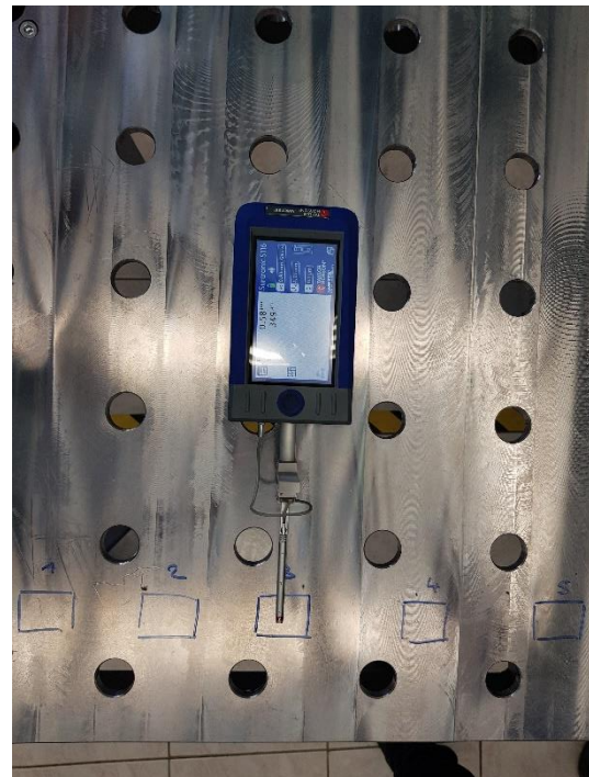
Slika 91. Mjerenje površinske hrapavosti na području 3
