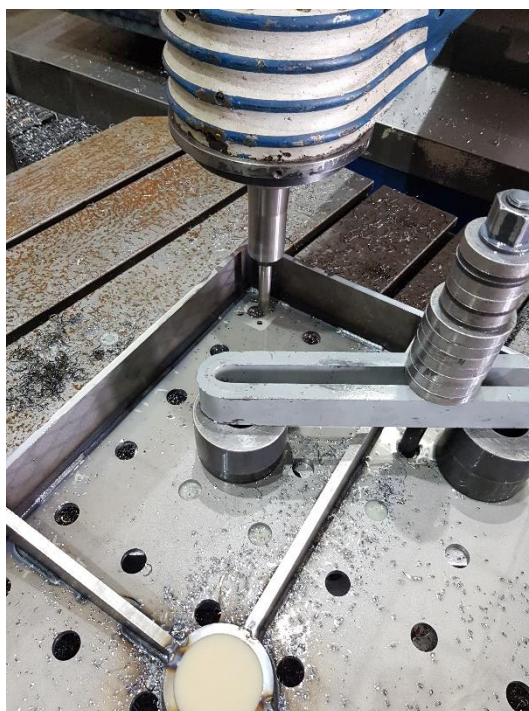
Slika 73. Glodanje džepa – 2. stezanje
