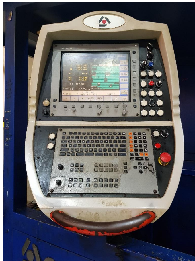
Slika 34. Upravljačka ploča Soraluze FR12000 obradnog centra
