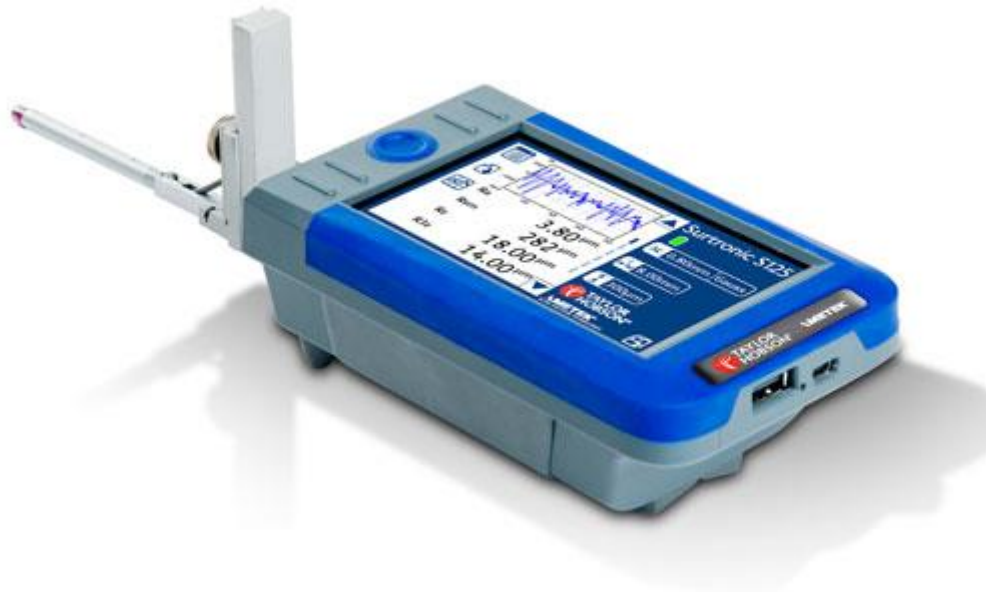
Slika 89. Uređaj AMETEK Taylor Hobson Surtronic S-100 Series
