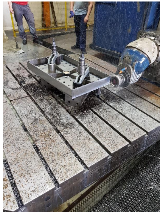
Slika 71. Čeono glodanje (grubo + završno) – 2. stezanje
