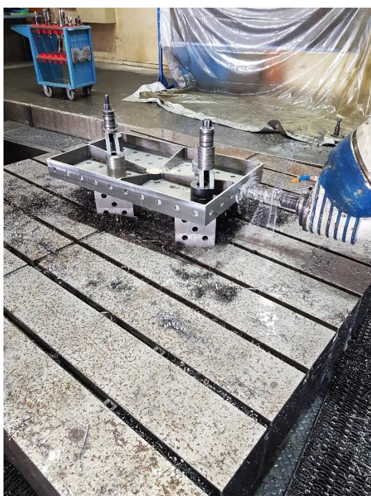
Slika 74. Bušenje provrta \varnothing 27 mm – 2. stezanje
