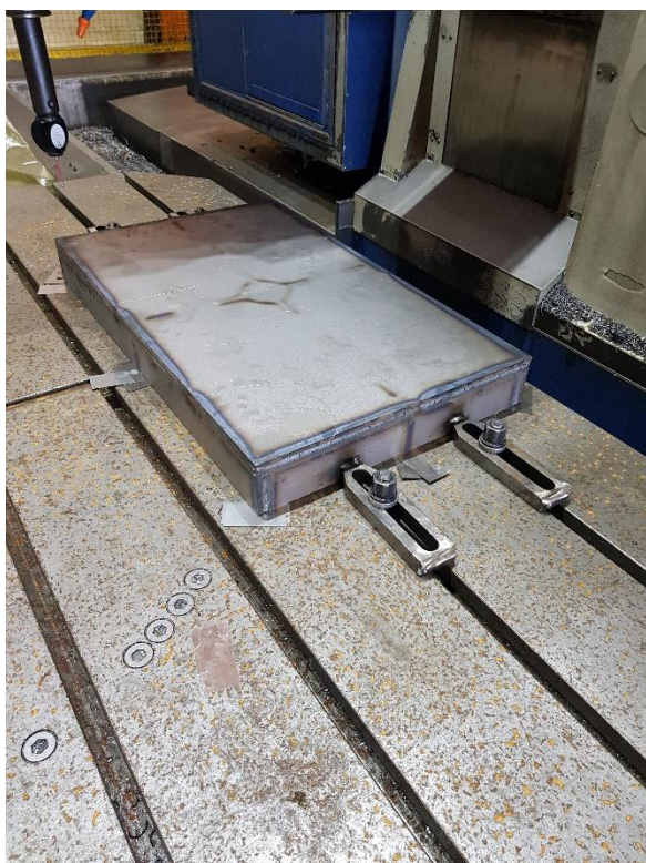
Slika 35. Priprema prvog stezanja
