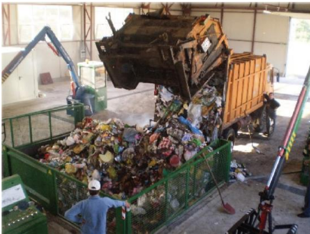
Slika 12. Kipanje prikupljenog otpada u prihvatno grotlo sortirnice [22]
