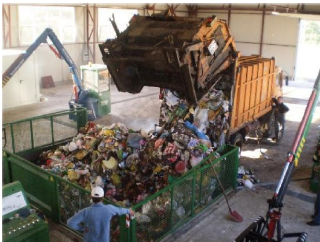
Slika 12. Kipanje prikupljenog otpada u prihvatno grotlo sortirnice [22]
