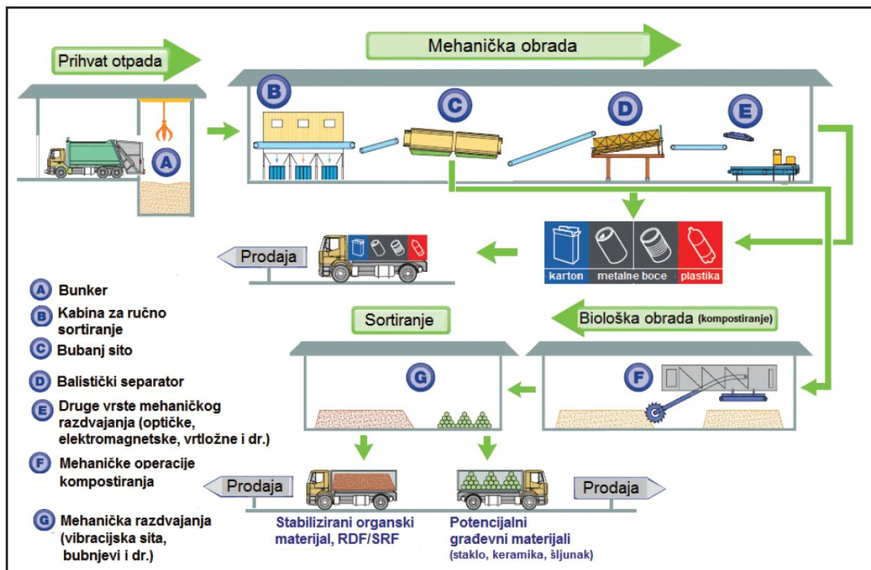
Slika 4. Shema postrojenja za mehaničku obradu [1]
