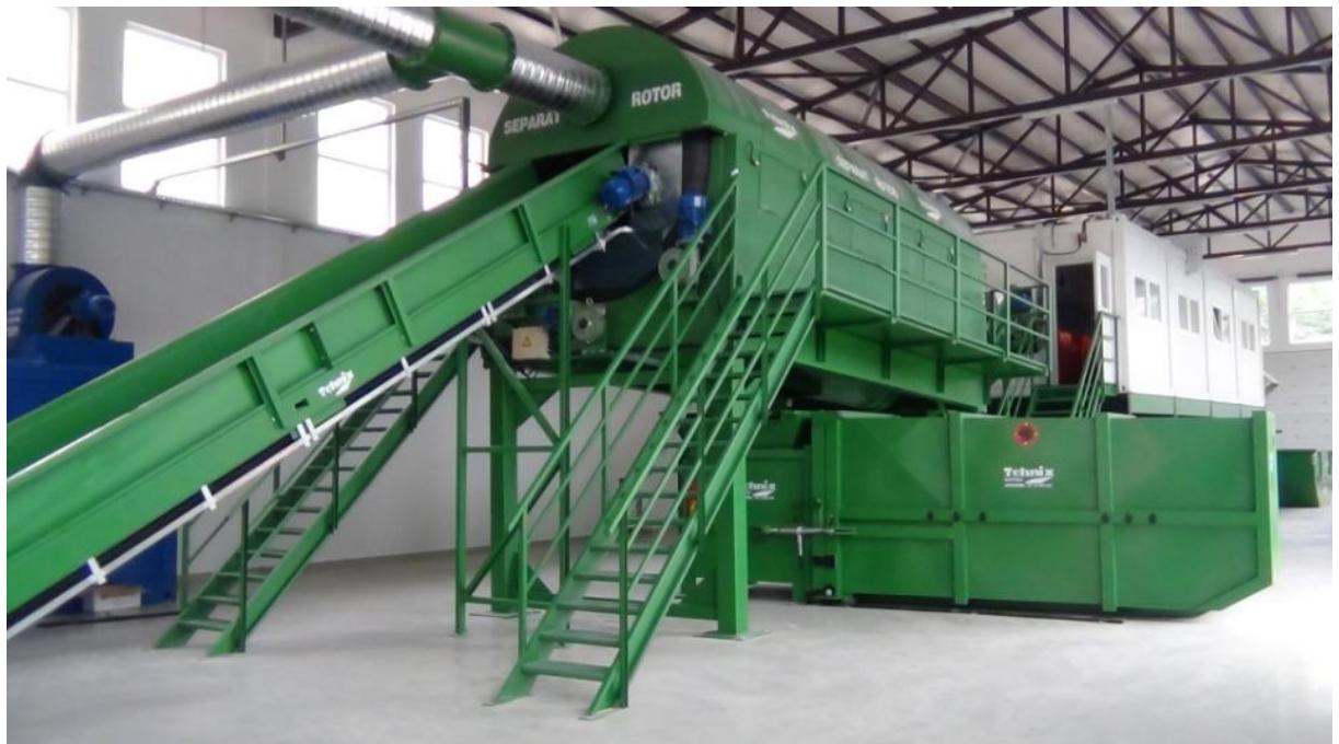
Slika 16. Separator rotor s kontejnerom ispod njega [23]
