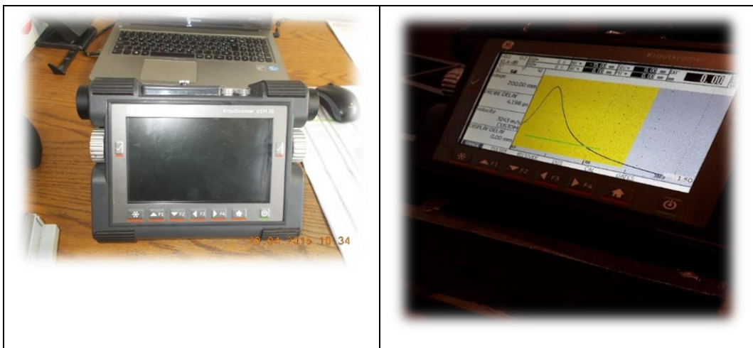
Slika 19. Uređaj za ultrazvučno ispitivanje Krautkramer USM 36
