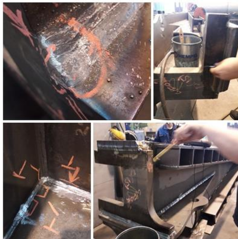
Slika 30. Vizualna kontrola i 1. faza ispitivanja
