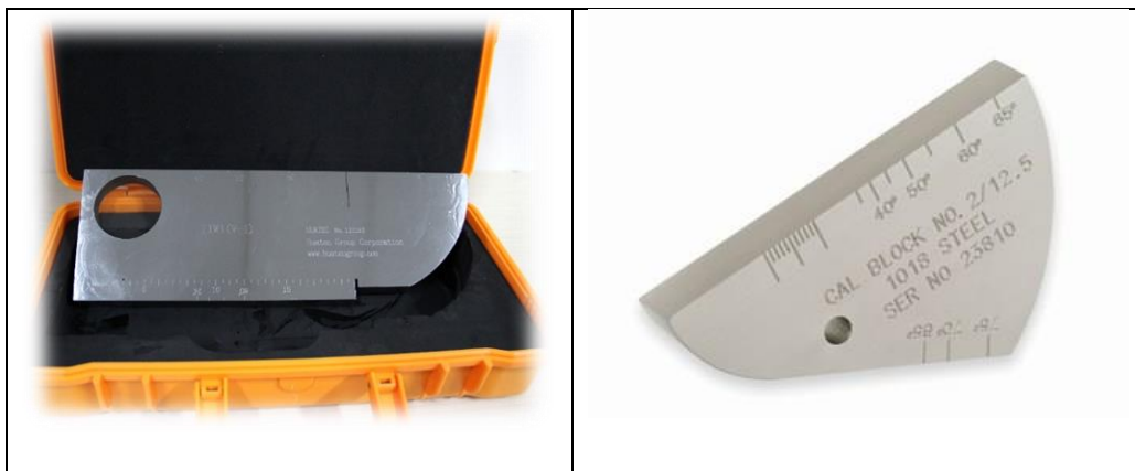
Slika 14. Kalibracijski blok K1 [4]
