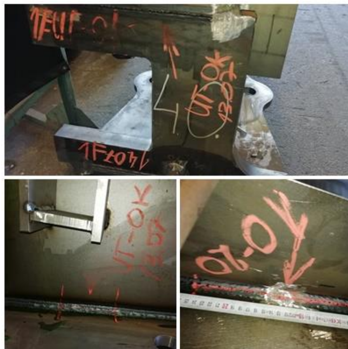
Slika 33. Oznake pogrešaka na SPOKE-u br. 2 tijekom ispitivanja
